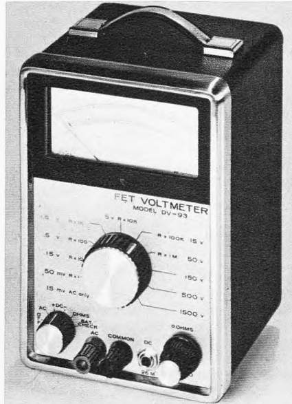
Das FET-Voltmeter, Modell DV-93, hat in den Gleichspannungsbereichen einen Eingangswiderstand von 26 \text{ M}\Omega und in den Wechselspannungsbereichen eine Eingangsimpedanz von 1 \text{ M}\Omega/40 \text{ pF}
