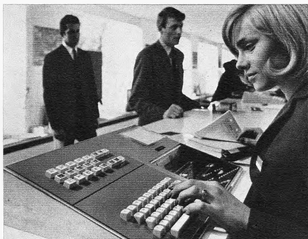
Bild 2. Buchungsplatz mit Bedienungs- und Anzeigenteil. Oben links ein Feld mit Leuchttasten zum Eingeben bestimmter Daten und Befehle. Unten links befindet sich die Fernschreibtastatur und oben rechts der Adapter für die Flugplankarten. Unten rechts ist die Ablage der Flugplankarten und ein Leuchtziffernfeld, auf dem ein Teil des Buchungstelegramms zur Kontrolle erscheint, erkennbar
